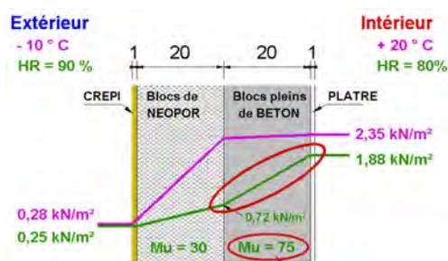
2. La résistance à la diffusion de la vapeur d'eau du mur en béton plein est importante.
