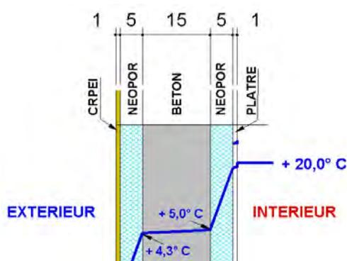
Notre exemple représente un mur en béton de 15 cm d'épaisseur isolé avec 5 cm de Neopor de chaque côté.
