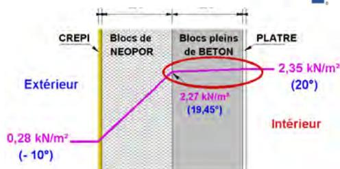
1. Du côté intérieur, la température du béton est élevée.
