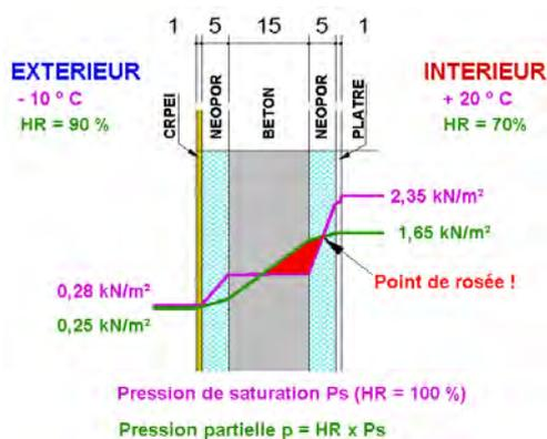
En effet, la vapeur d'eau à une température et une humidité relative données se condense lorsque la pression partielle  $p$  devient la pression de saturation  $P_s$  pour une température plus basse, appelée point de rosée.
