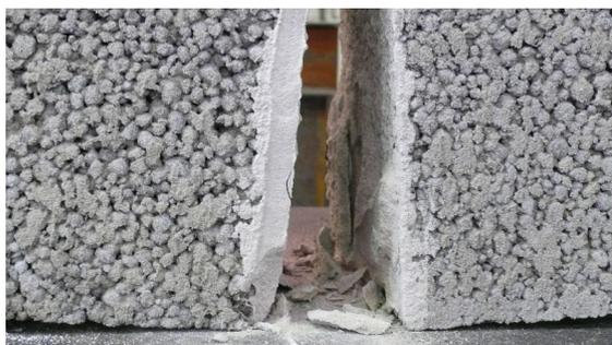
Le joint de mortier est le point faible de la maçonnerie
