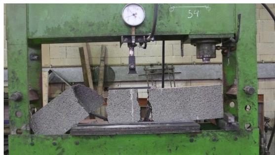
La rupture se fait au niveau des blocs d'argex.
