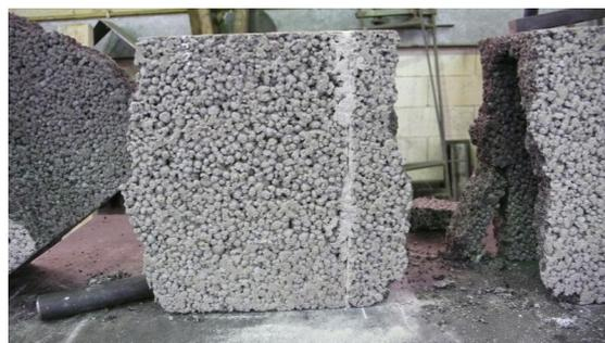
Le joint de mortier-colle est le point fort de la maçonnerie.
