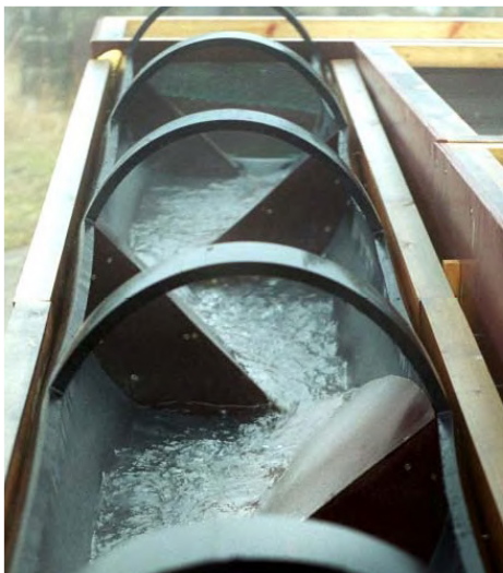
Essai non concluant avec déflecteurs à 45°
